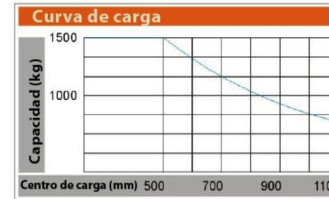
NOTA: Diagrama de carga con horquillas standard y centro de gravedad 500 mm. Si utiliza otras horquillas y/o centro de carga diferente, consulte al fabricante.
