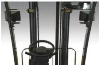
El nuevo diseño del mástil de gran visibilidad permite una mejor visión del operario a la zona de carga, mejorando el confort y la seguridad de su manejo.
